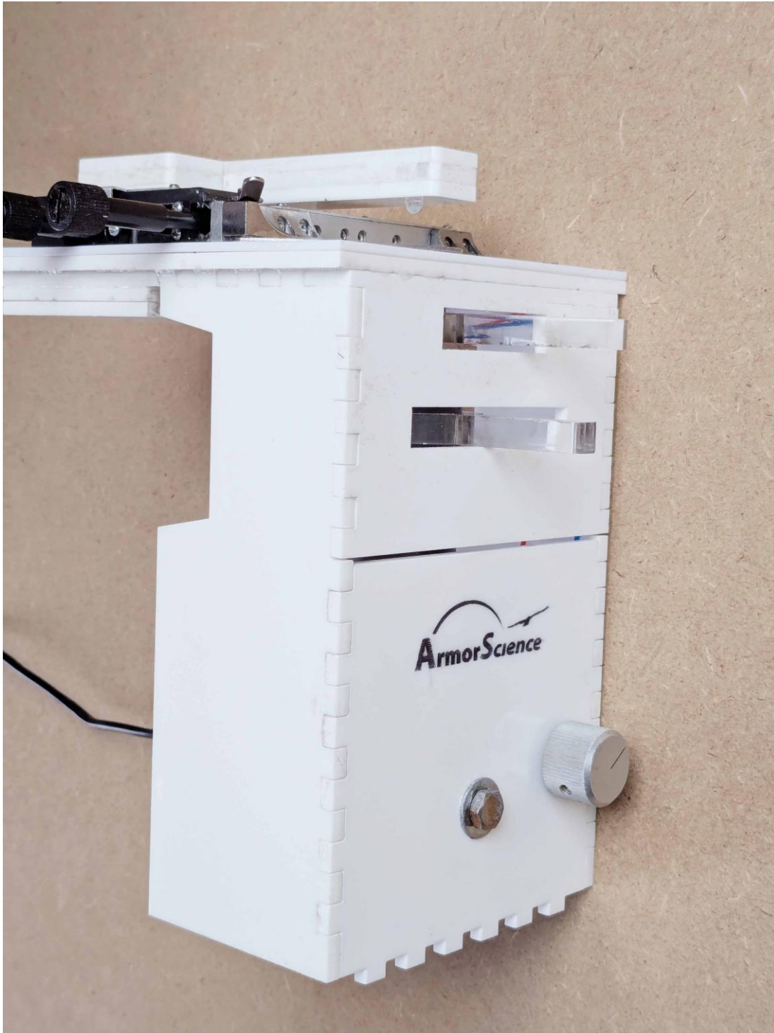
Figure 44 : Le châssis interne avec tous les éléments montés et fonctionnels
