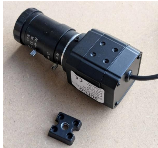
Figure 38 : Le socle de fixation démonté pour être re-taraudé
