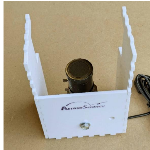
Figure 36 : La caméra fixée par un boulon et une rondelle de diamètre 6 mm
