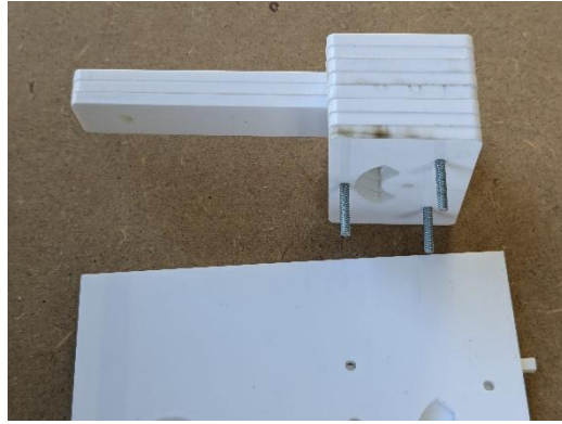
Figure 20 : Le support de LED muni de ses entretoises
