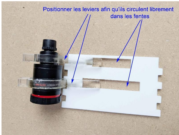
Figure 37 : Calcul de la position des leviers
