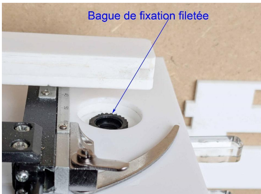
Figure 42 : Serrage de l'objectif par la bague de fixation filetée
